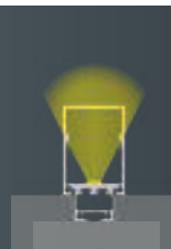
Einbau mit Universalkabel- kanal und Abdeckung K
