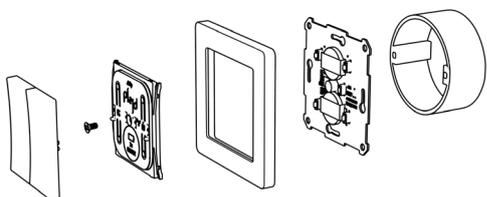
Montage à l'extérieur d'un boîtier avec des vis.
