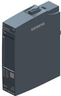
SIMATIC ET 200SP, Digitales Eingangsmodul, DI 8x 24VDC Basic, Eingangstyp 2 (IEC 61131), Sink Input, (PNP, P-lesend), Verpackungseinheit: 1 Stück, passend für BU-Typ A0, Farbcode CC01, Eingangsverzögerung 0,05..20ms; Modul-Diagnose für: Versorgungsspannung
