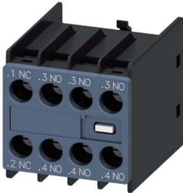
Hilfsschalter, frontseitig, 3 S + 1 Ö, .1/2, .3/4, .3/4, .3/4, Strombahn: 1 Ö, 1 S, 1 S, 1 S Schraubanschluss, für Schütze 3RT2 und Hilfsschütze 3RH2
