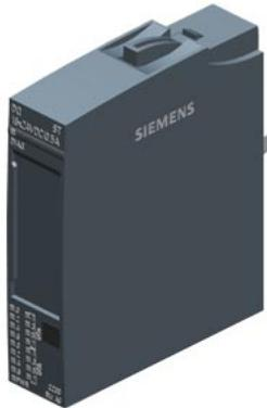
SIMATIC ET 200SP, Digitales Ausgangsmodul, DQ 16x 24V DC/0,5A Standard, Source Output (PNP,P-schaltend) Verpackungseinheit: 1 Stück, passend für BU-Typ A0, Farbcode CC00, Ersatzwertausgabe, Modul-Diagnose für: Kurzschluss nach L+ und M, Drahtbruch, Versorgungsspannung
