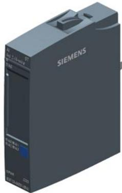
SIMATIC ET 200SP, analoges Eingangsmodul, AI 4xI 2-/4-Wire Standard, Verpackungsmenge: 1 Stück, passend für BU-Typ A0, A1, Farbcode CC03, Modul-Diagnose, 16 Bit, +/-0,3%
