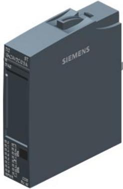
SIMATIC ET 200SP, module de sortie TOR, DQ 16x 24 V CC / 0,5 A Standard, Sortie source (PNP, commutation P) colisage: 1 unité, convient pour type de BU A0, Code couleur CC00, sortie de la valeur de remplacement Diagnostic de module pour : Court-circuit sur L + et M, rupture de fil, tension d'alimentation
