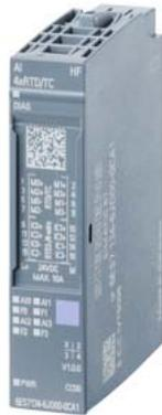
SIMATIC ET 200SP, module d'entrées analogiques, AI 4xRTD/TC High Feature, convient pour type de BU A0, A1, Code couleur CC00, diagnostic de voie, 16bits, +/-0,1 %, 2-/3-/4-fils
