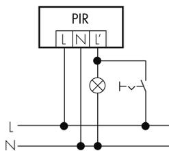
**Betrieb mit Drehschalter «Hand - 0 - Automat»**
