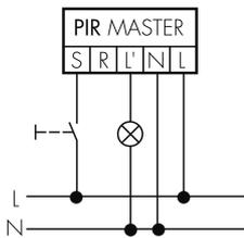
Betrieb mit Drehschalter «Hand - 0 - Automat»
