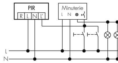
Fonctionnement avec interrupteur rotatif «Manuel - 0 - Automatique»
