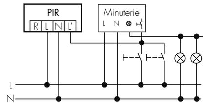
Fonctionnement avec interrupteur rotatif «Manuel - 0 - Automatique»
