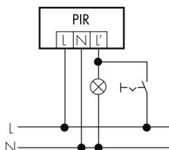
Fonctionnement avec interrupteur rotatif «Manuel - 0 - Automatique»
