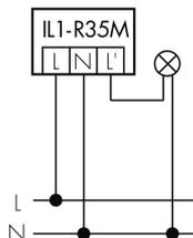
Fonctionnement normal avec luminaire externe et circuit RC
