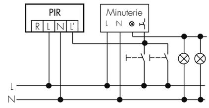
Fonctionnement avec interrupteur rotatif «Manuel - 0 - Automatique»
