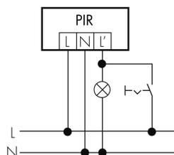
Funzione con commutatore rotativo «Manuale - 0 - Automatico»
