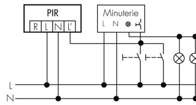
Funzione con commutatore rotativo «Manuale - 0 - Automatico»
