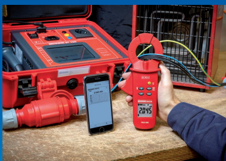
Schutzleiterstrommessung im Differenzstromverfahren und Aufzeichnung per App in Echtzeit
