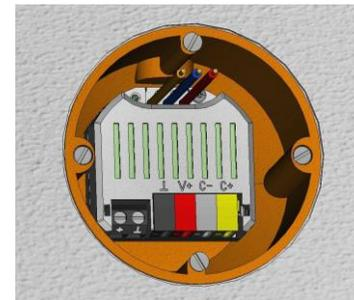
**HINWEIS!** Zum Lösen eines Drahtes aus der Push-in Klemme halten Sie ihn fest und ziehen Sie ihn durch gleichzeitiges Hin- und Herdrehen aus der Klemme heraus.
