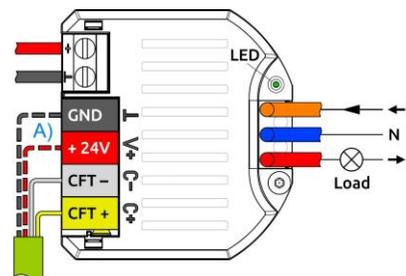
**HINWEIS!** Bei kurzen Leitungen und geringem Spannungsabfall kann das Gerät alternativ über die Leitung mit den Massivdrähten (Ø0,8 mm) gespeist werden. Verbinden Sie dazu die Klemmen wie im Bild unten.
