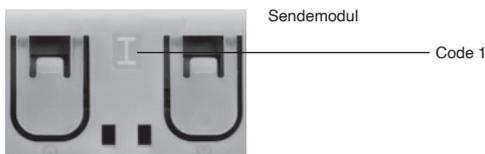
⚠ Zum Einstellen von Sonderfunktionen/Modus am Empfänger muss die Position von Code I/O am Sender bekannt sein.
