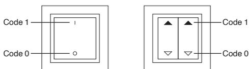
Die ALADIN-Wandsender gehören zum ALADIN-Funksystem. Mit einem Tastendruck auf den batterieellosen und wartungsfreien Wandsender können Verbraucher drahtlos mit den ALADIN-Empfängern geschaltet werden. Beim Drücken (und Loslassen) der Wippe des Wandsenders wird über einen Bügel ein Energiewandler zur Energieerzeugung betätigt. Jeder Sender verfügt über eine einmalige Identifikations-Adresse.
