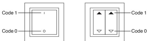
Les émetteurs muraux ALADIN font partie du système radio ALADIN. Il suffit d'appuyer sur une touche des émetteurs muraux sans pile et ne nécessitant aucun entretien pour connecter à distance des consommables via les récepteurs de commutation ALADIN. Presser ou (relâcher) la touche de l'émetteur mural active un convertisseur d'énergie. Chaque émetteur dispose d'une unique adresse d'identification.
