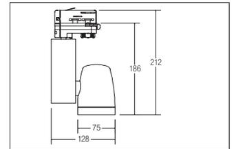
LED-Schienenstrahler, weiß, rund. Ausführung in kompakter Bauform für die harmonische Implementierung in stimmige, architektonische Raumkonzepte. Inkl. Betriebsgerät, schaltbar.
