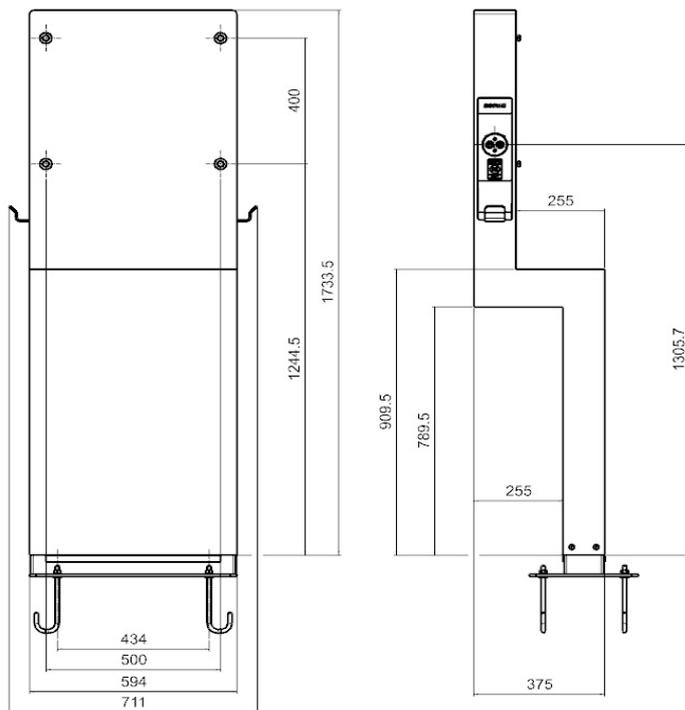
\* Montage mit Betonzangen (im Lieferumfang enthalten)
