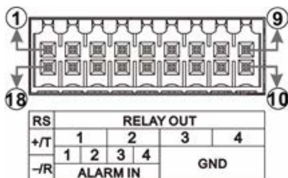
Fig. 1: Schema di numerazione dei pin dei connettori I/O di allarme di MOVE NVR-16.
