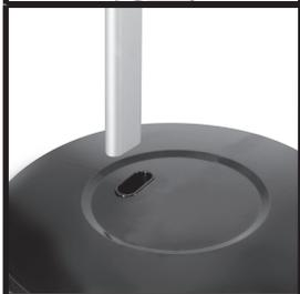
Remplacez le profil en aluminium sur le pied en plastique et appuyez jusqu'à ce qu'il se verrouille.
