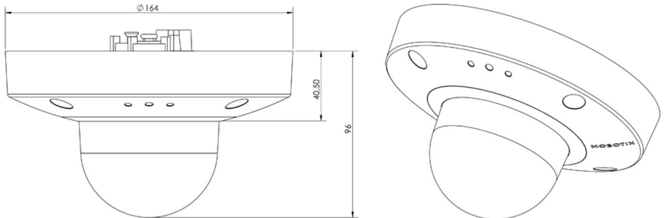
Abb. 1: MOBOTIX v71: Alle Maßangaben in mm
