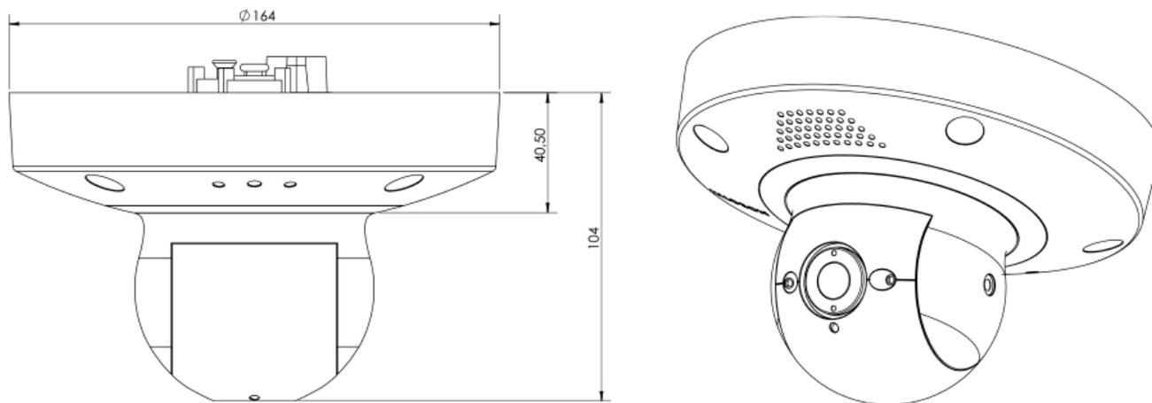
Abb. 1: MOBOTIX p71: Alle Maßangaben in mm
