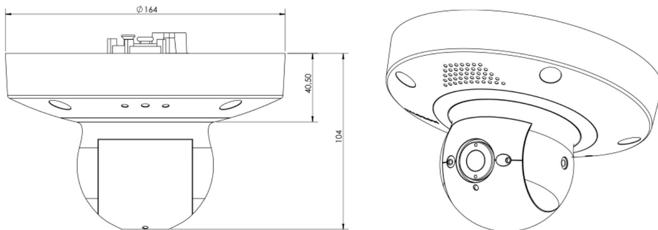
Fig. 1: MOBOTIX p71: Tutte le misurazioni in mm
