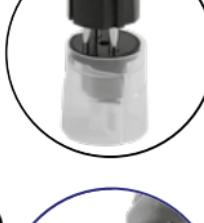
Drücken Sie den Gerätestecker bündig in den Fixadapter.
