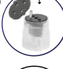
Stellen Sie den Fixadapter auf eine ebene Fläche und legen Sie die Dichtung auf.
