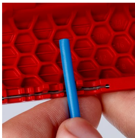
90 22 02 SB : graduation injectée pour un dénudage homogène sur une longueur uniforme, lisible pour les droitiers et les gauchers
