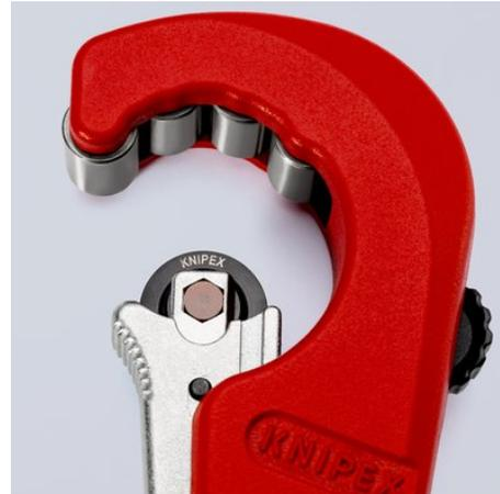
Per tagliare tubi in rame, ottone, acciaio inossidabile e tubi corrugati in acciaio con uno spessore della parete fino a 2 mm e un diametro di 6 - 35 mm (1/4" - 1 3/8")
