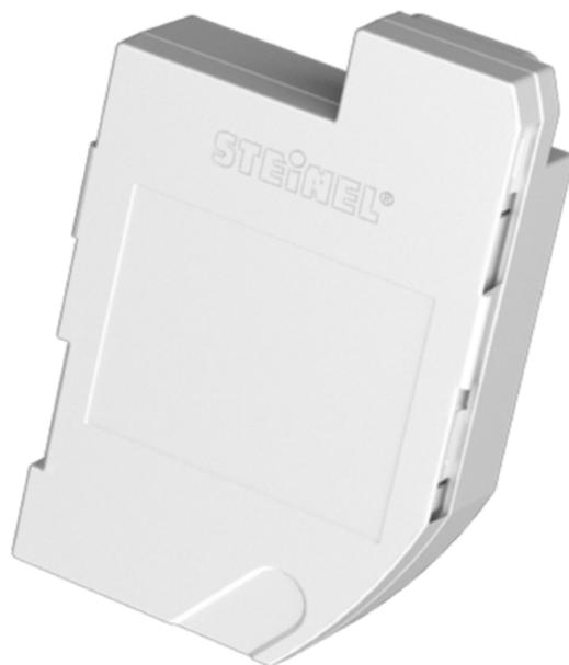
Module d'éclairage de secours en option pour les luminaires RS PRO Connect de la série R, allume automatiquement, e cas de panne de courant, un éclairage de secours à LED (107 lm) pendant 3 heures selon la norme EN 60598-2-22. 3 batteries AA sont également fournies.
