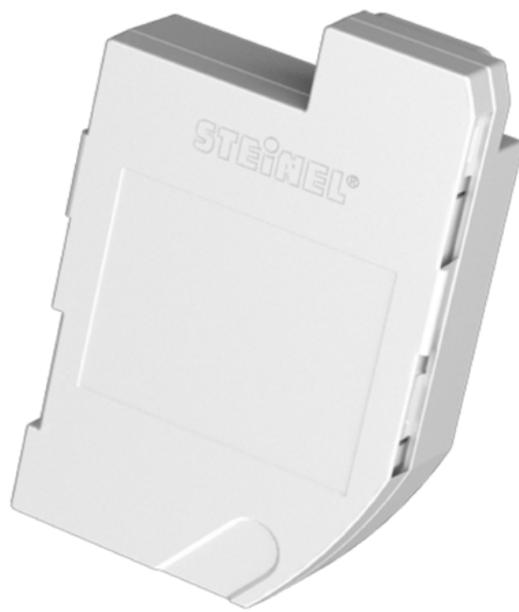
Optionales Notlichtmodul für die RS PRO Connect R-Leuchten, schaltet automatisch bei einem Stromausfall ein LED-Notlicht (107 lm) nach EN 60598-2-22 für 3 Stunden. 3 AA Akkus sind im Lieferumfang enthalten.
