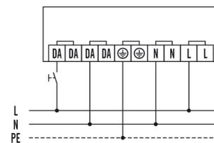
Raccordement avec fonction optionnelle par SwitchDIM (PushDIM).
