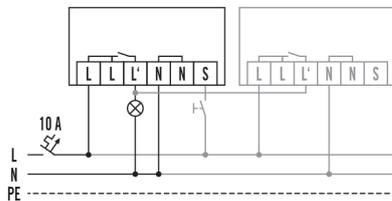
Standardbetrieb mit optionaler Ansteuerung durch Schliesstaster und Parallelschaltung von max. 8 Geräten
