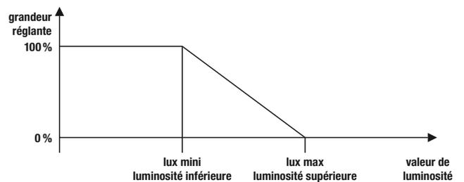
Réglage de la modification minimale et maximale de la valeur de variation (0...10 %), actif pendant la régulation et la commande
