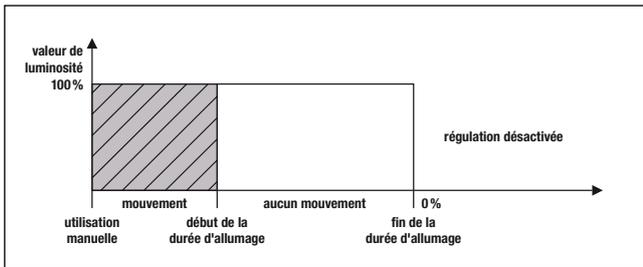
Commande manuelle pendant le temps de verrouillage
