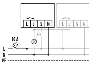
Standardbetrieb mit optionaler Ansteuerung durch Schliesstaster und Parallelschaltung von max. 6 Geräten
