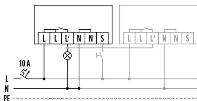
Standard con controllo opzionale tramite pulsante di chiusura e cablaggio parallelo di max. 8 dispositivi.
