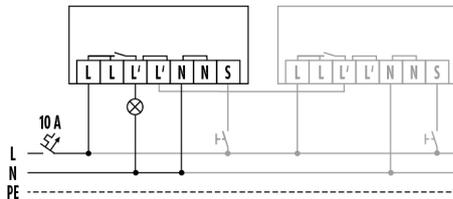
Installation standard avec commande en optionnelle par poussoir et raccordement en parallèle de 8 appareils au maximum
