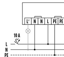
Raccordement standard avec raccordement optionnel de luminaires externes
