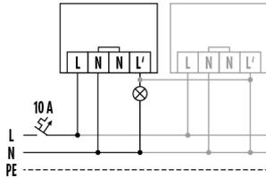
Funzionamento standard con cablaggio parallelo opzionale di max. otto rilevatori di movimento.
