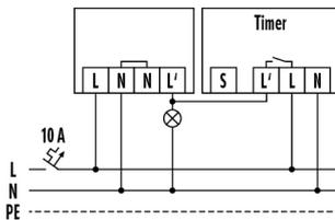
Funzionamento standard con illuminazione automatica delle scale.
