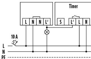
Funzionamento standard con illuminazione automatica delle scale.
