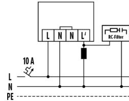
Quando si collegano gli induttori (ad esempio relè, contattori, ballast), può essere necessario utilizzare un filtro (A).
