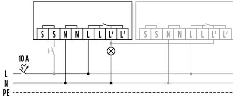
Funzionamento standard con controllo opzionale tramite pulsante di chiusura e cablaggio parallelo di max. dieci dispositivi.
