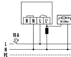
Bei Schaltung von Induktivitäten (z. B. Relais, Schütze, Vorschaltgeräte) kann der Einsatz eines Löschgliedes (A) erforderlich sein.
