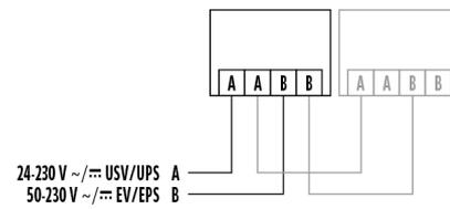
Funzionamento standard con collegamento in serie opzionale ad altre luci di emergenza.
