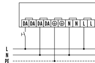
Raccordement avec commande optionnelle par poussoir SwitchDIM (PushDIM).
