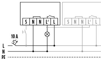
Funzionamento standard con controllo opzionale tramite pulsante di chiusura e cablaggio parallelo di max. dieci dispositivi.
