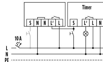
Funzionamento standard con illuminazione automatica delle scale e controllo opzionale tramite pulsante di chiusura.
