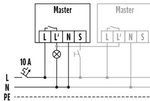
Funzionamento standard con controllo opzionale tramite pulsante di chiusura e cablaggio parallelo di max. 8 dispositivi
