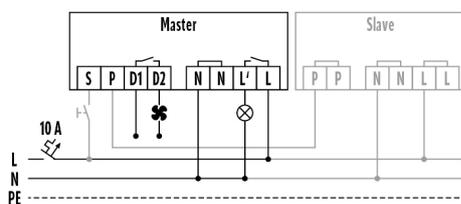
Funzionamento standard con controllo opzionale tramite pulsante di chiusura e utilizzo di max. dieci dispositivi slave con un dispositivo master
